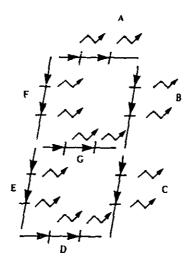
Fig. 6.10: Seven-Segment LED
