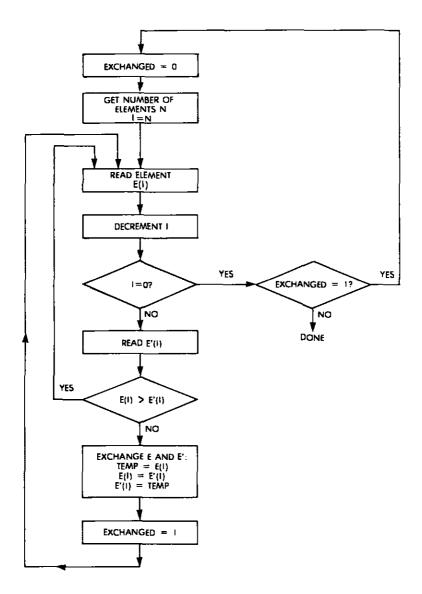
Fig. 8.7: Bubble-Sort Flowchart
