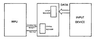
Fig. 6.8a: Handshaking (Input)
